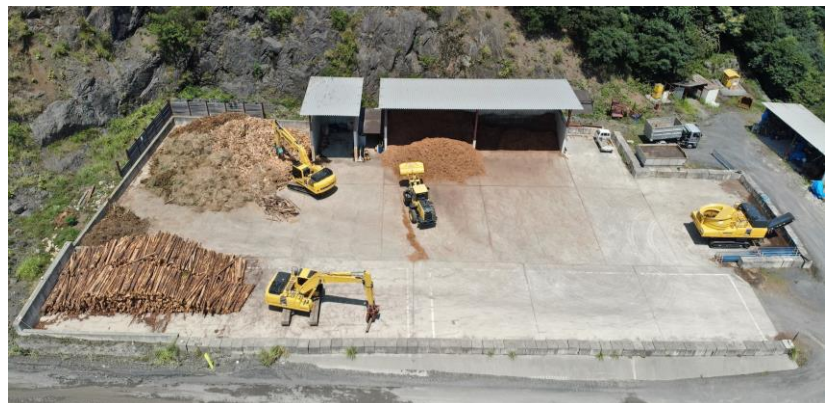
建設廃材から木質バイオマスチップを製造 (株)サクセス
