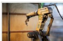
プラズマ切断機
